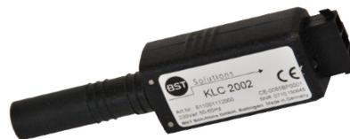
Der KLC 2002 (G) bewertet nur das Flackern der zu überwachenden Flamme. Optional ist eine Geräteausführung mit Störfrequenzabschaltung erhältlich. Gleichlichtstrahlung und jegliche konstanten Frequenzen führen hierbei nicht zu einer dauerhaften Flammenerkennung. Störende Fremdlichtquellen, z. B. von Leuchtstoffröhren oder niederfrequente Hintergrundstrahlungen von glühenden Ausmauerungen werden ausgeblendet. Ungewollte Beeinflussungen der Flammenerkennung können hierdurch vermieden werden.
