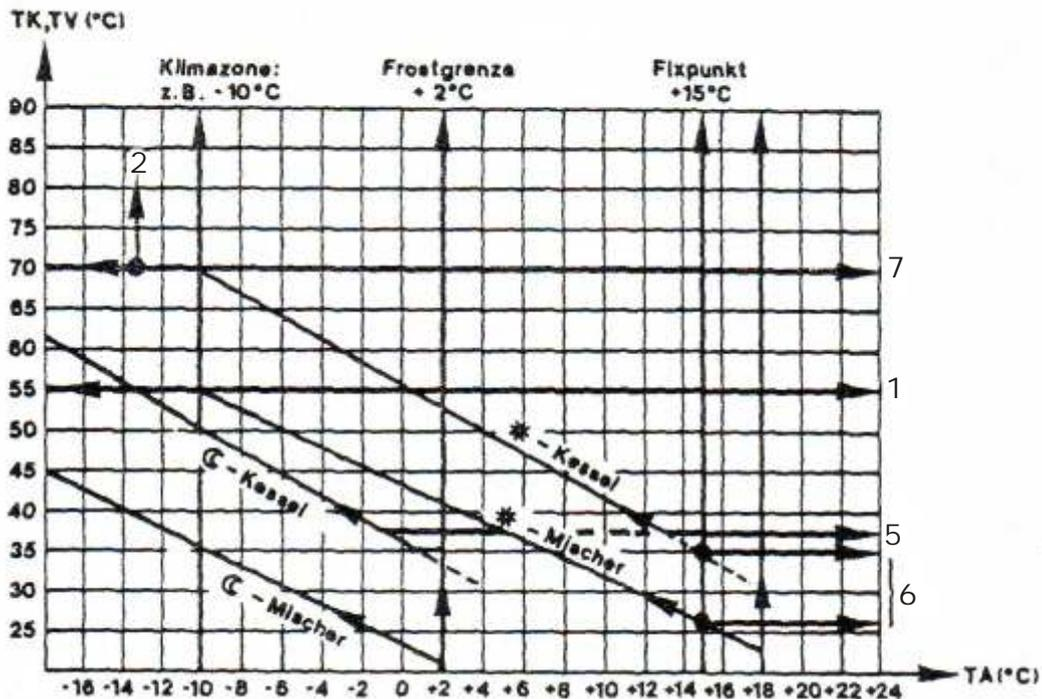
Die Heizkennlinie zeigt den Zusammenhang zwischen der Aussentemperatur und der Heizungs-Vorlauftemperatur. Eine höhere Vorlauftemperatur bewirkt eine grössere Energieabgabe. Die Heizkennlinie ist bestimmt durch ihre Steilheit S (0 bis 2,4) einstellbar an den Drehknöpfen 3 und 4.
