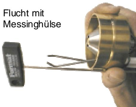
2. Elektrodenabstand (5 mm)
