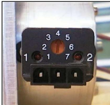
Leuchtdiode 2 zeigt den jeweiligen Schaltzustand des Fühlers an:
