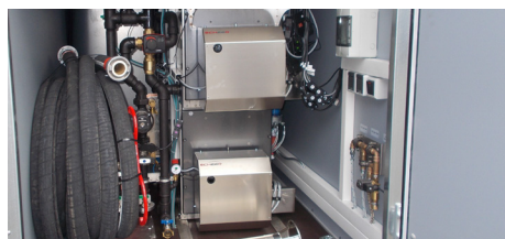
Beste Redundanz mit zwei integrierten 70 kW Heizsystemen
