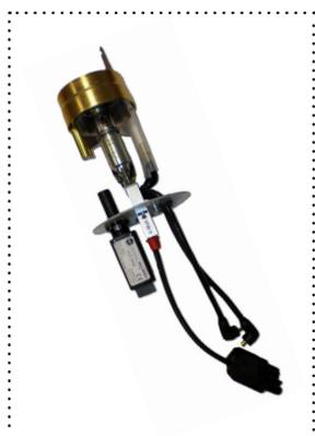
Mischeinrichtung, Öldüse, Zündelektroden mit steckbaren Anschlusskabeln, Ölvorwärmer und Flammenüberwachung sind in einer kompakten Baueinheit zusammengefasst. Ein Bajonettverschluss sichert schnelle, problemlose Servicearbeiten.
