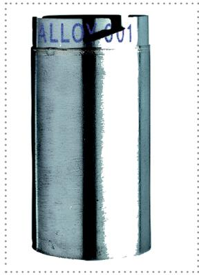
Das Flammenrohr wirkt als eigenständige Brennkammer. Der **Blautherm® DUO** ist damit auf allen marktüblichen Heizkesseln einsetzbar. Mit seinem Bajonettverschluss ist das Alloy-Flammenrohr sehr schnell demontierbar, dies erleichtert die Servicearbeiten.
